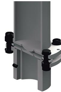
Vertikalabstützung zur Vermeidung zu starker axialer Beanspruchung der Lamellenpakete durch das Gewicht der Zwischenhülse
